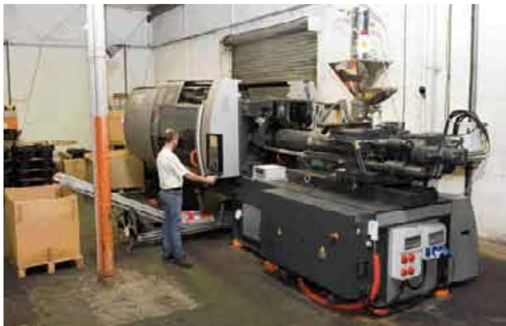
Pour la production des composants plastiques, la société vient d'investir dans une nouvelle presse à injection qui dispose d'une capacité de 480 tonnes en fermeture pour 1 800 cm 3 de volume d'injection.
