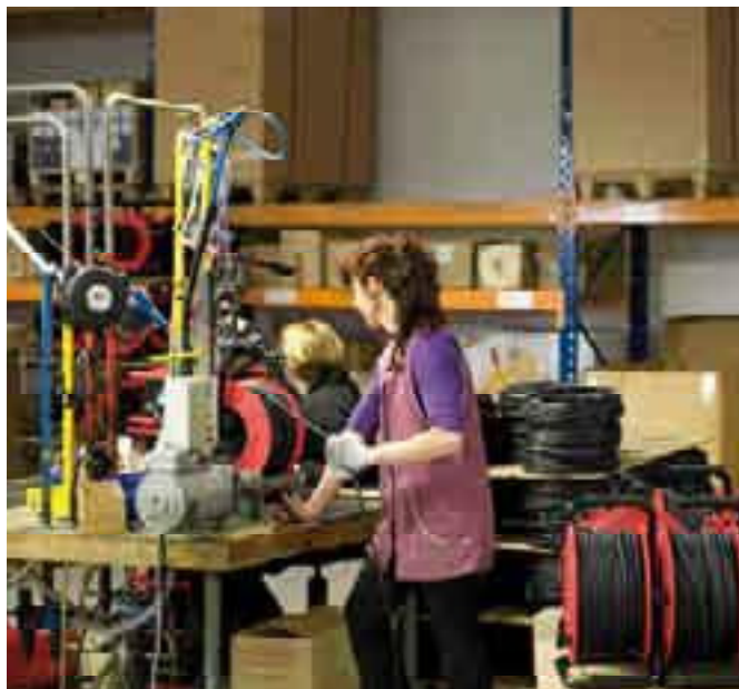
Afin de garantir un montage de qualité, les câbles sont montés manuellement sur les fûts des enrouleurs.
