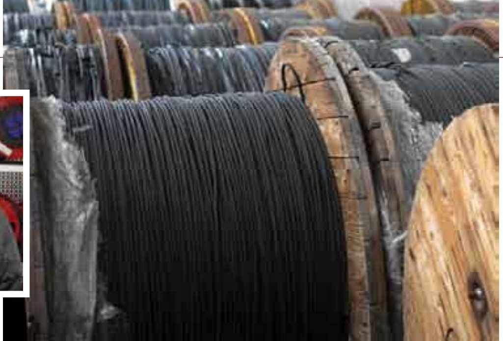
Les câbles utilisés pour la fabrication des enrouleurs professionnels sont en néoprène, une matière souple et résistante idéale pour des utilisations sur chantiers.
